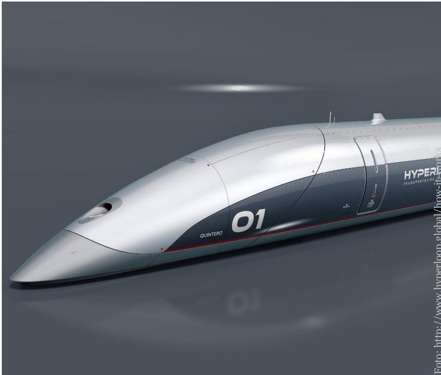
2013 stellte Tesla- und SpaceX-Gründer **Elon Musk** den Hyperloop vor. Seine Idee: Menschen in Kapseln in einer **Fast-Vakuurröhre** von einem Ort zum nächsten zu transportieren. Und das mit Geschwindigkeiten von über 1.000 km/h. Damit ist das Transportsystem über Rohrsysteme nicht nur umweltschonend und vermindert das Verkehrsaufkommen, sondern auch extrem schnell und damit zeitsparend. Kurze Zeit nach der Präsentation zog sich Musk aus der Entwicklung zurück und gab das Konzept frei.
